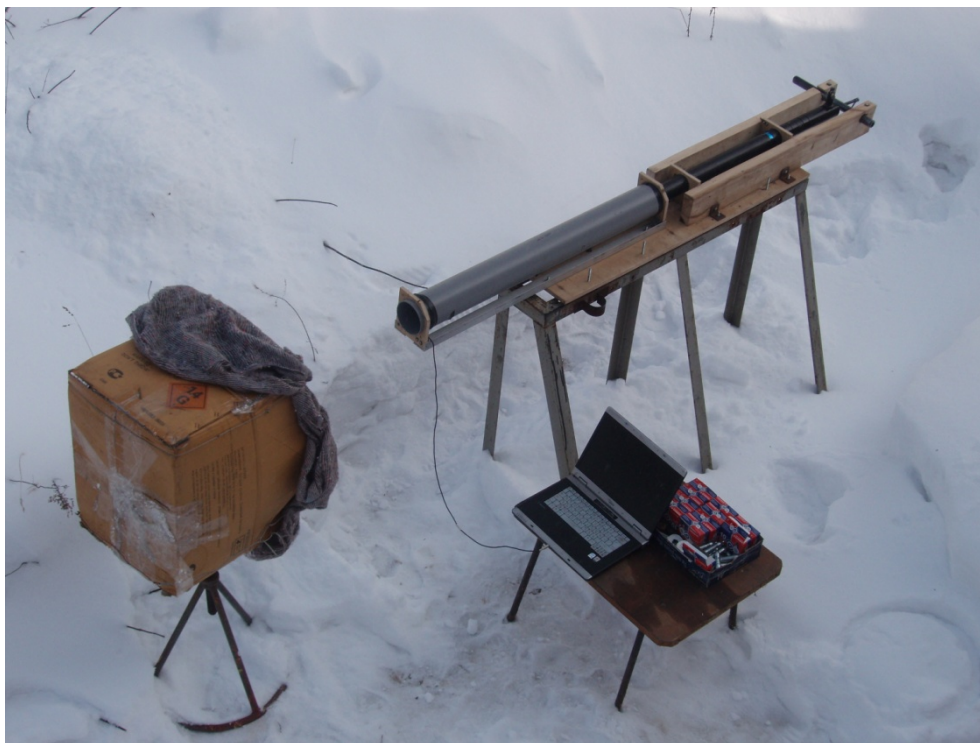
Рис. 2. Общий вид экспериментальной установки – ударной трубы в комплекте с измерительным комплексом и уловителем имитатора
